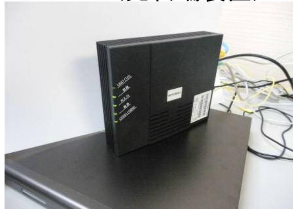
D-ONUの正常時のランプ状態 登録・光入力・電源が緑点灯。UNIT2が緑点滅。 ※インターネット・テレビに加入の場合はUNIT1が緑点滅。
