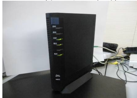
HGWの正常時のランプ状態 接続・電話・電源が緑点灯 ※通信がたまに点滅。
